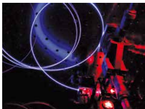
Testaufbau eines Hochleistungs-Thulium-Faserlasers für optronische Gegenmaßnahmen
